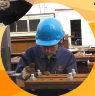
↑ 鉄板を鉄骨に ボルトで固定 →
